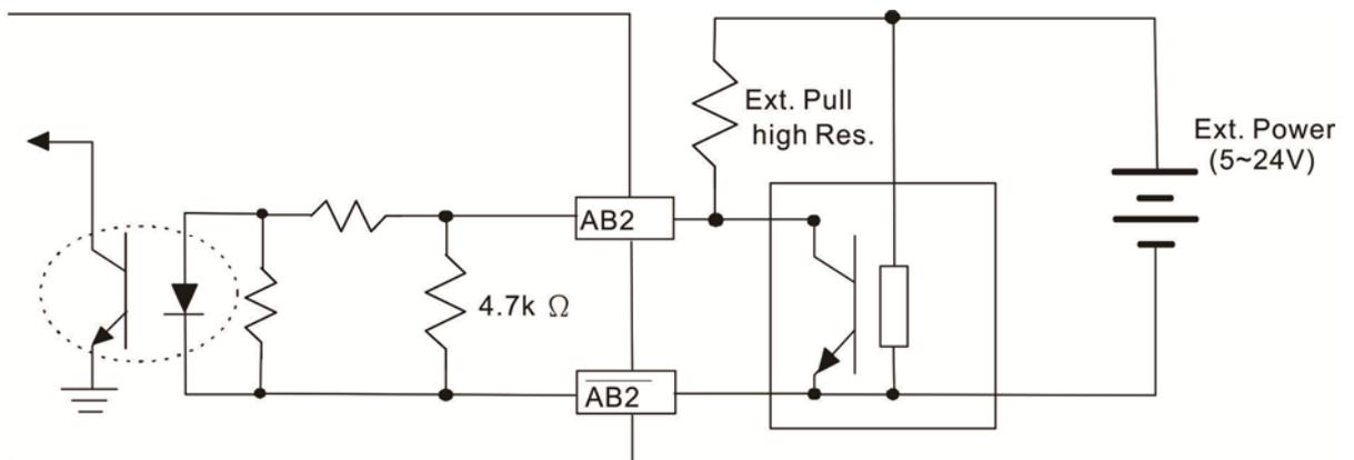
■ **EMC-PG010/EMC-PG020 Wiring Diagram**
