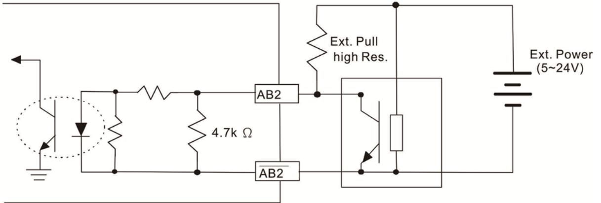
■ **EMC-PG01L/EMC-PG02L Wiring Diagram**
